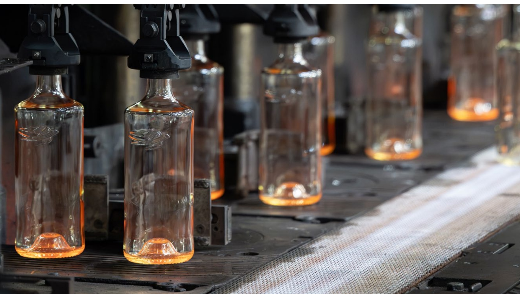
Bouteilles Martell qui sortent du four verrier 100% électrique de Verallia, sur le site de Cognac.
